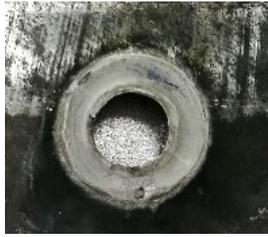
Abbildung 6: Bruchbild einer "kalten" Schweißstelle
