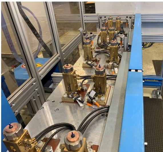
Abbildung 9: Buckelschweißvorrichtung mit ModulMaster
