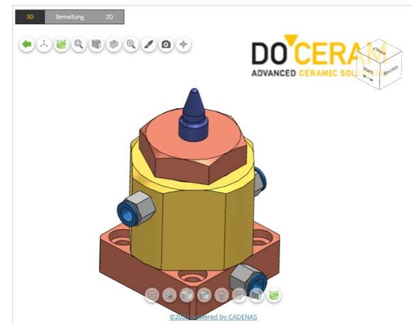
Abbildung 8: Komplettelektrode für Mutter M10
