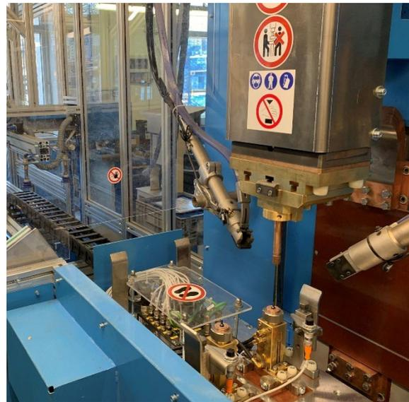
Abbildung 10: KE-Schweißanlage mit Zuführung
