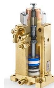
Ganz besonders deutlich wird das beim einem Premiumprodukt in der Widerstandsschweißtechnik. Mit der neu entwickelten Modul-Master-Pro® stellt DOCERAM ein Produkt vor, welches in dritter Generation alle Anforderungen an eine Buckelschweißvorrichtung beachtet. Darin sind die Erfahrungen von mehr als 500 bereits im Einsatz befindlichen Systemen verarbeitet.
