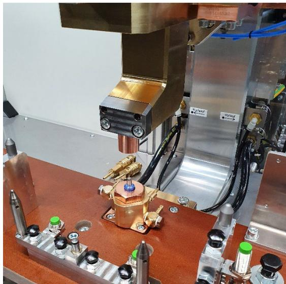
Abbildung 3: Schweißvorrichtung an Bauteil angepasst
