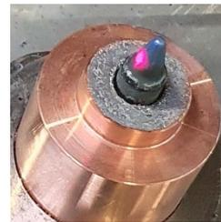
Abbildung 4: Elektrode mit Verschleißspuren
